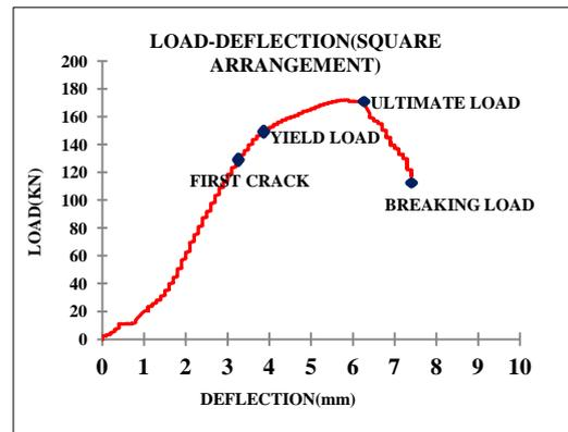
**FIG-15 LOAD-DEFLECTION BEHAVIOR OF SQUARE ARRANGEMENTS OF STUDS**
