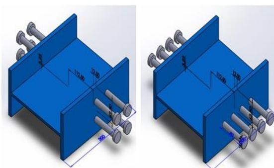
FIG-1: ARRANGEMENTS OF STUDS ON FLANGE PORTION OF I-BEAM USING SOLID-WORKS
