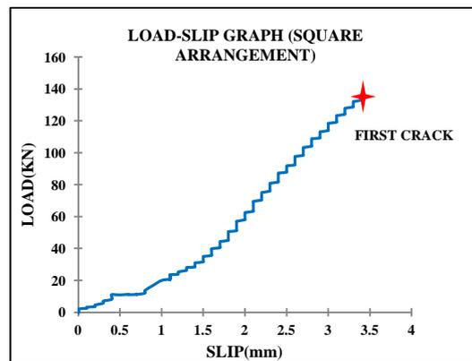
**FIG-16 LOAD-SLIP BEHAVIOR OF SQUARE ARRANGEMENTS OF STUDS**
