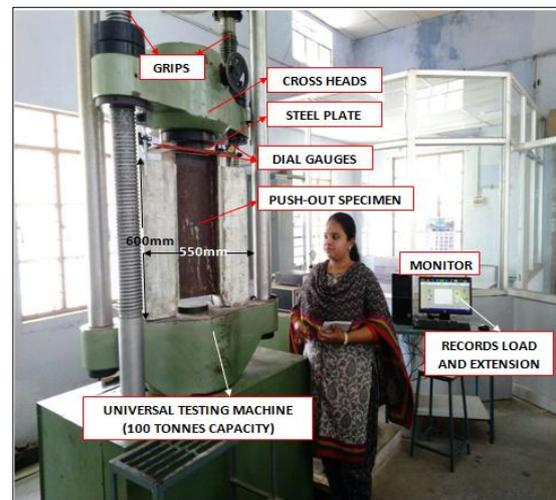
FIG-9 PUSH-OUT TEST SETUP
